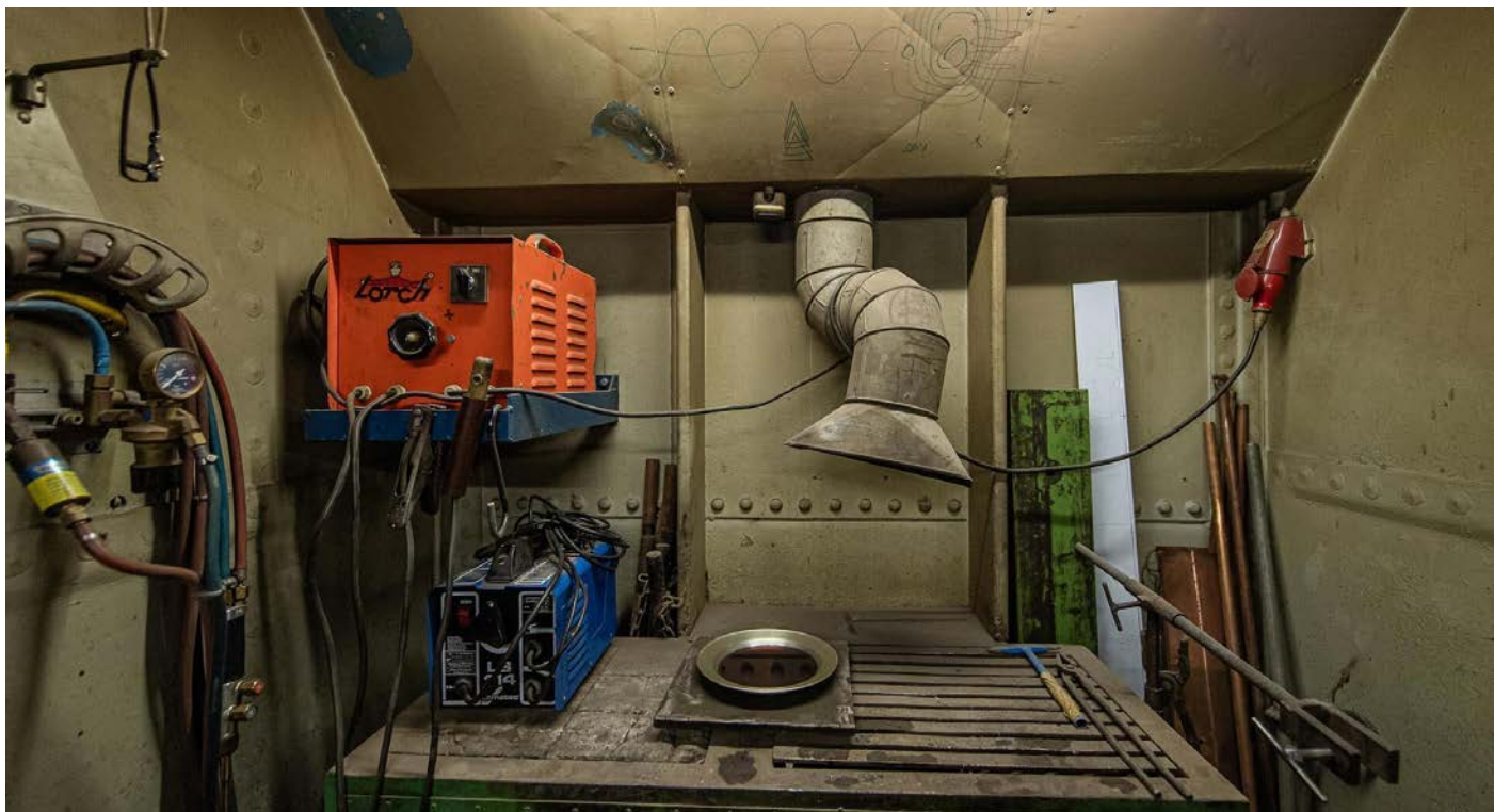
Die Nieten verraten, dass wir uns nicht in einer Werkstatt an Land, sondern in einem Schiff befinden. Foto: Polgesek
